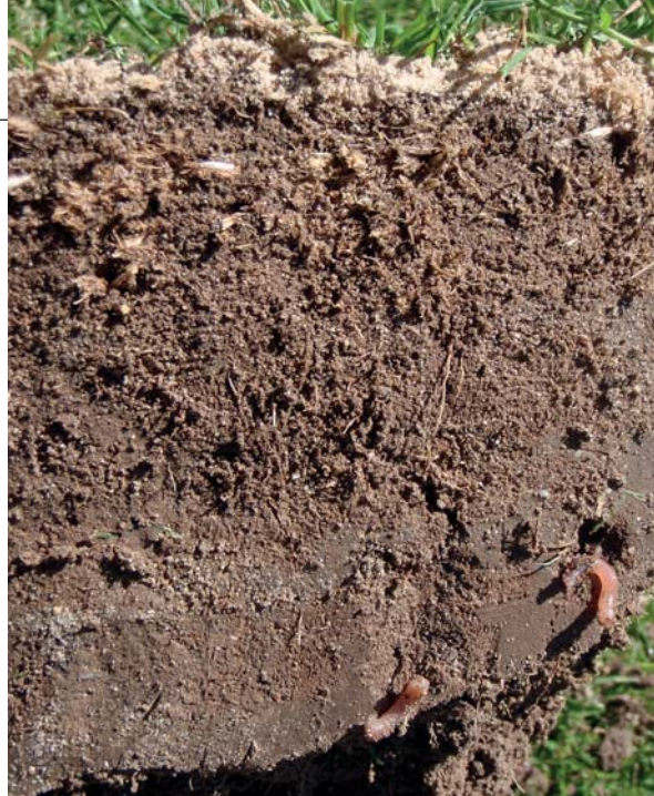
Figur 3: Hvor hurtigt vand kan lade sig infiltrere ned gennem vækstlaget og hvor meget vand, der fortsat vil være bundet i vækstlaget afhænger af, hvor tæt jorden er lejret. Vandet kommer ofte aldrig ned til drænene. På billedet har grenkeeperen topdresset fairways konsekvent over en årrække. På denne måde har han opbygget en gradueret sandtop ovenpå den ellers lerholdige fairway. Foto: Asbjørn Nyholt.
