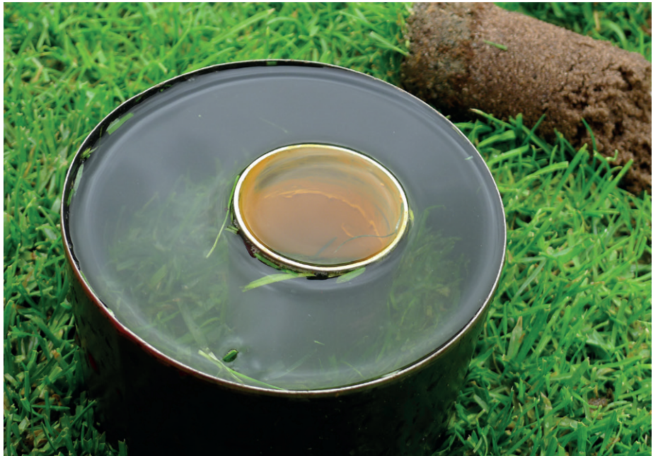
Billede 9: Selv et meget tyndt lag filt kan hindre infiltration af vand og gasudveksling i vækstjorden. Billedet er fra en boldbane, som blev etableret med vasket rullegræs. Foto: Agner Kvalbein.
